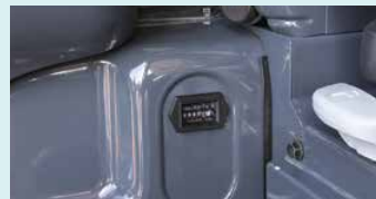
Horamètre visible depuis l'extérieur
