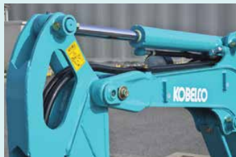
Les flexibles du vérin de godet sont protégés par la structure du balancier
