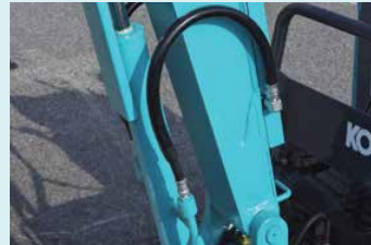
Auslegerzylinder-Schläuche aus zwei Teilen
