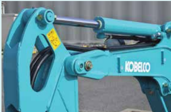
Löffelzylinderschläuche befinden sich im Stiel
