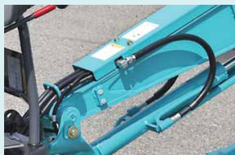
Copertura protettiva per i flessibili dietro al braccio di sollevamento
