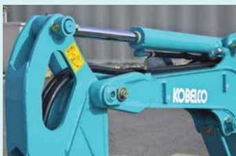
Flessibili del cilindro della benna inseriti all'interno del braccio di scavo
