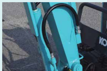
Flessibili del cilindro del braccio di sollevamento in 2 parti
