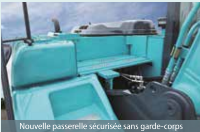
Nouvelle passerelle sécurisée sans garde-corps
