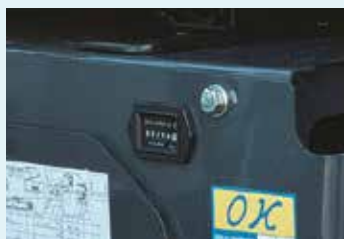
Horamètre visible de l'extérieur
