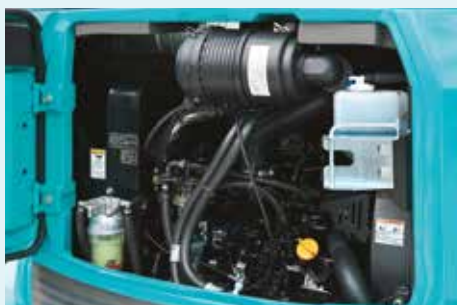
Filtre à carburant principal hautes performances
