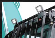
Kabinendach vorne (2 Leuchten)
