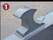
Anker Zum Biegen langer Objekte.
