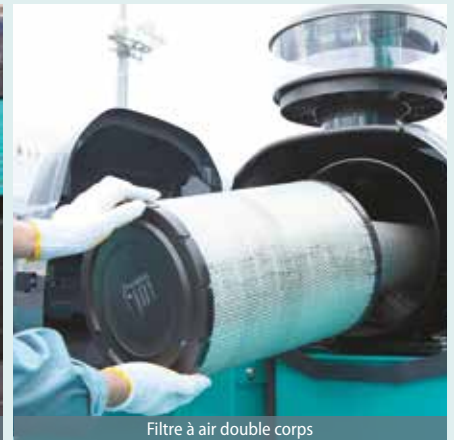
Filtre à air double corps
