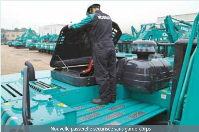
Nouvelle passerelle sécurisée sans garde-corps
