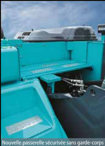
Nouvelle passerelle sécurisée sans garde-corps
