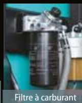
Filtre à carburant avec décanteur d'eau intégré
