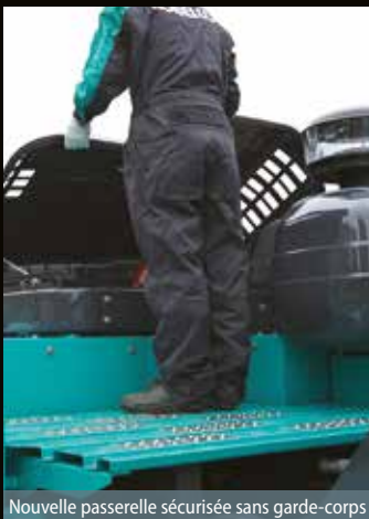
Nouvelle passerelle sécurisée sans garde-corps
