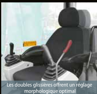
L'inclinaison du siège va jusqu'à la mise à plat du dossier
