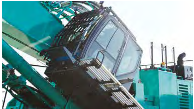
La cabine s'incline jusqu'à 30 degrés pour mieux visualiser l'outil au travail en grande hauteur, et dans une position de confort de conduite idéale pour le chauffeur.
