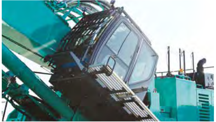
Ein Neigungswinkel der Kabine von 30 Grad bietet eine optimale Position und Sicht bei längeren Arbeiten in der Höhe.
