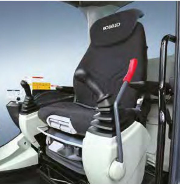
Luftfederter Sitz mit Rücken- und Nackenstütze reduziert Ermüdungserscheinungen
