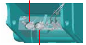
Telecamera sul braccio di lavoro
