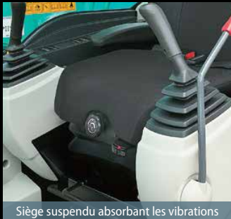
Siège suspendu absorbant les vibrations
