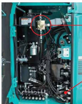
Vanne de sélection simple ou double effets du circuit hydraulique auxiliaire
