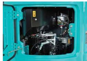
Une cloison sépare le compartiment des pompes du moteur
