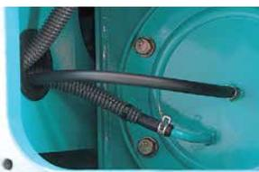
Réservoir à carburant équipé d'une trappe en partie basse et d'un grand robinet de vidange.
