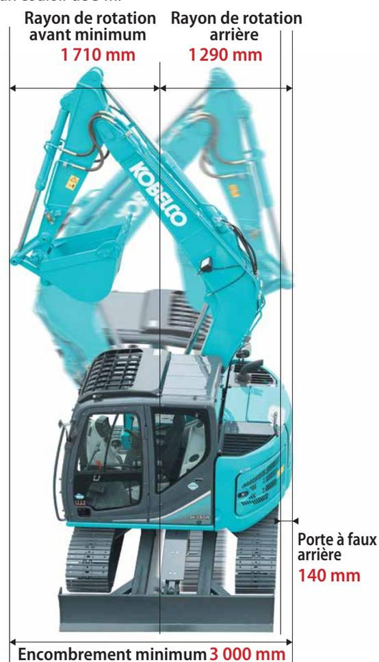
L'encombrement minimum est la somme du rayon de rotation avant minimum et du rayon de rotation arrière.
