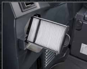
Filtre à air extérieur de climatisation
